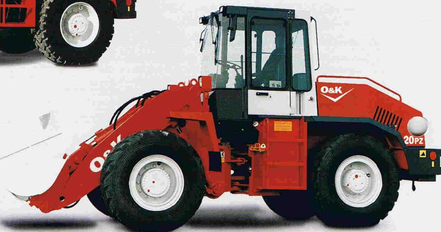
Die Radader L 15 PZ/L 20 PZ sind echte Multi-Talente. Ihre patentierte Hubtechnik verbindet die Vorteile der reißstarken Z-Kinematik mit den Pluspunkten der Parallel-Kinematik.
