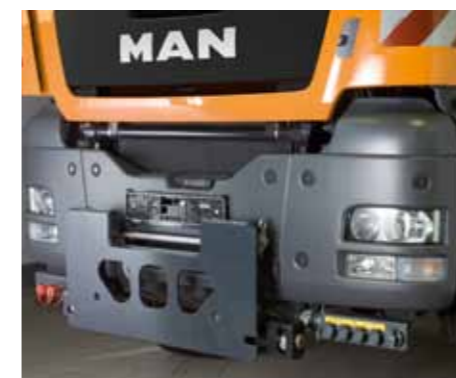
Genormte Anbauplatte für Vorbaugeräte auf Wunsch.
